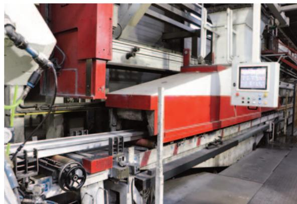
Elle traite 45 tonnes d'aluminium chaque jour pour fabriquer 60 000 m de profilés. La seconde ligne, qui entrera en fonction courant 2023, sera installée dans la travée d'à côté, en parallèle de la première, sur environ 130 m de long.
