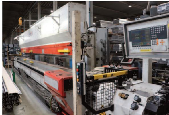
Plus productive, cette Aluroller à commande numérique permet de modifier les réglages plus facilement : le crantage des deux demi-profilés positionnés l'un en haut l'autre en bas, puis l'insertion des deux barrettes sont réalisés au premier passage. Le sertissage est fait au retour. Deux personnes travaillent à ce poste.
