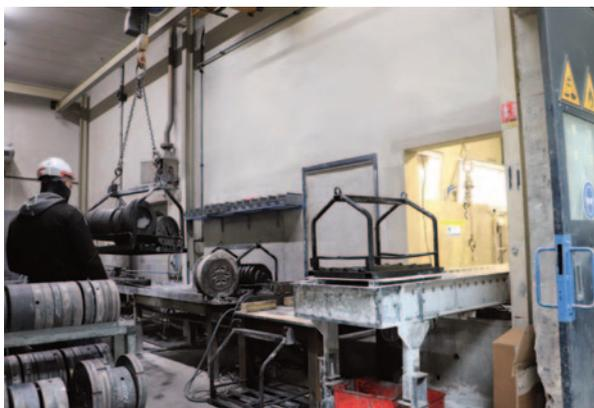
Les filières sont démontées et nettoyées des résidus d'aluminium par un bain de soude. Un pont permet de plonger les filières dans ces deux bacs au cycle automatisé, puis de les diriger vers le rinçage. ▼
