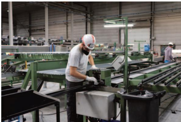
Cette barretteuse Muller, plus productive, est adaptée aux grandes séries mais nécessite quatre personnes pour diverses opérations manuelles. Le profil circule d'une machine à l'autre : la première réalise un crantage le long de la barre ; les barrettes sont positionnées sur les demi-profilés positionnés l'un au-dessus de l'autre. Une autre machine sertit l'ensemble.
