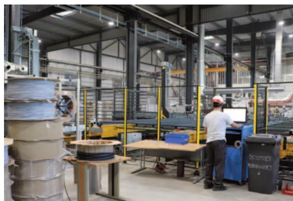
Les flux vers les services additionnels sont mieux intégrés et gérés informatiquement, ce qui évite de transporter les profils vers les ateliers. Ici, un « tunnel » permet de diriger la barre à jointoyer vers la jointoyeuse à trois têtes de montage, entièrement automatique qui fonctionne à pleine cadence depuis novembre 2021.
