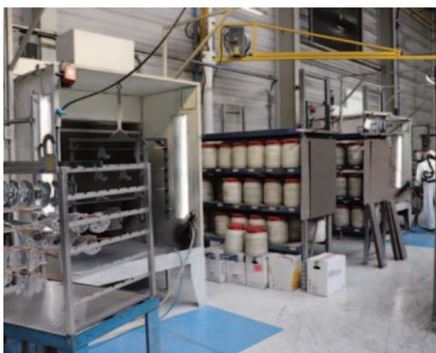
Deux cabines de poudrage permettent de laquer les accessoires et des postes de montage. Ici, des poignées.
