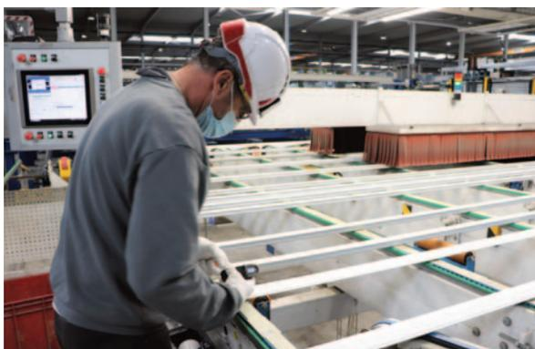
Les profils sont décrochés et leur aspect contrôlé visuellement. D'autres vérifications sont effectuées aléatoirement (pour les labels Qualicoat et Qualmarine) : épaisseur de peinture, brillance et adhérence, résistance de la laque et colorimétrie.
