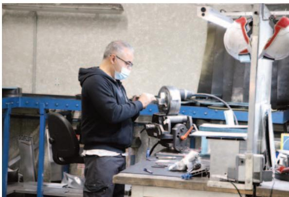
Pour obtenir et maintenir la qualité des profils après utilisation, un travail de précision est réalisé sur les filières. Dix ans sont nécessaires pour former un régleur confirmé.
